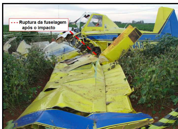
Figura 4 - Ruptura da fuselagem após o impacto.
