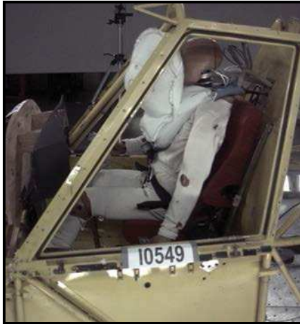
Figura 6 - Uso de um boneco para demonstrar a funcionalidade do airbag na aeronave AT-502B.
