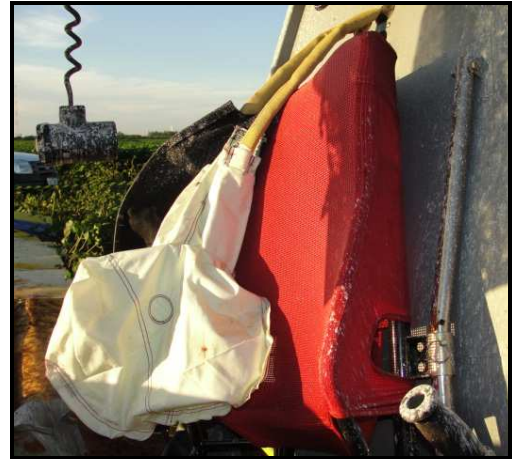
Figura 7 - Foto que indica o acionamento do airbag da aeronave PR-VAR.
