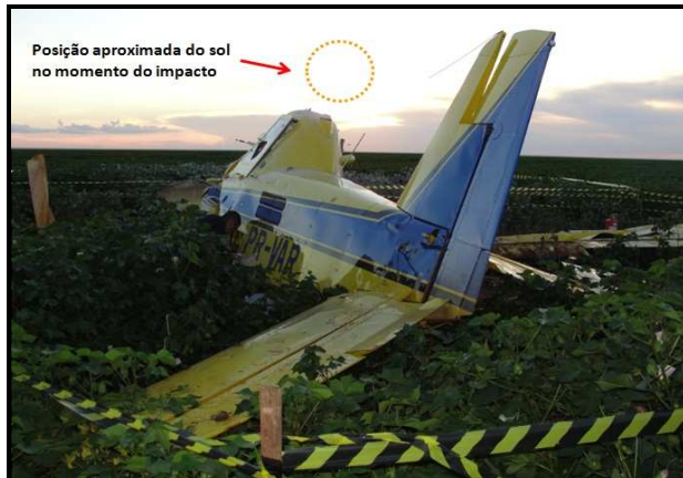
Figura 9 - Ruptura do estabilizador horizontal esquerdo em decorrência do impacto.
