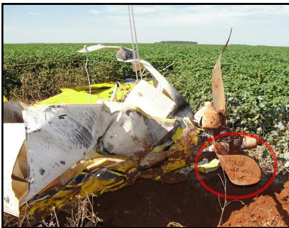
Figura 8 - Pá da hélice, destacada pelo círculo vermelho, indicando que o motor desenvolvia alta potência no momento do impacto contra o solo.
