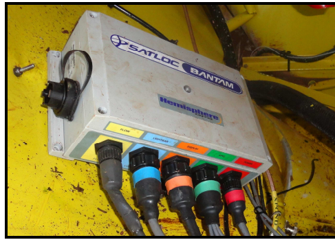
Figura 1 - CPU do equipamento GPS da aeronave PR-VAR.
